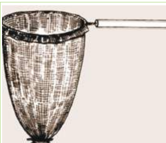
Figura 2 - O cabide funcionará como armação para a rede, sendo este fixado ao cabo de vassoura com auxílio de fita isolante ou arame.
